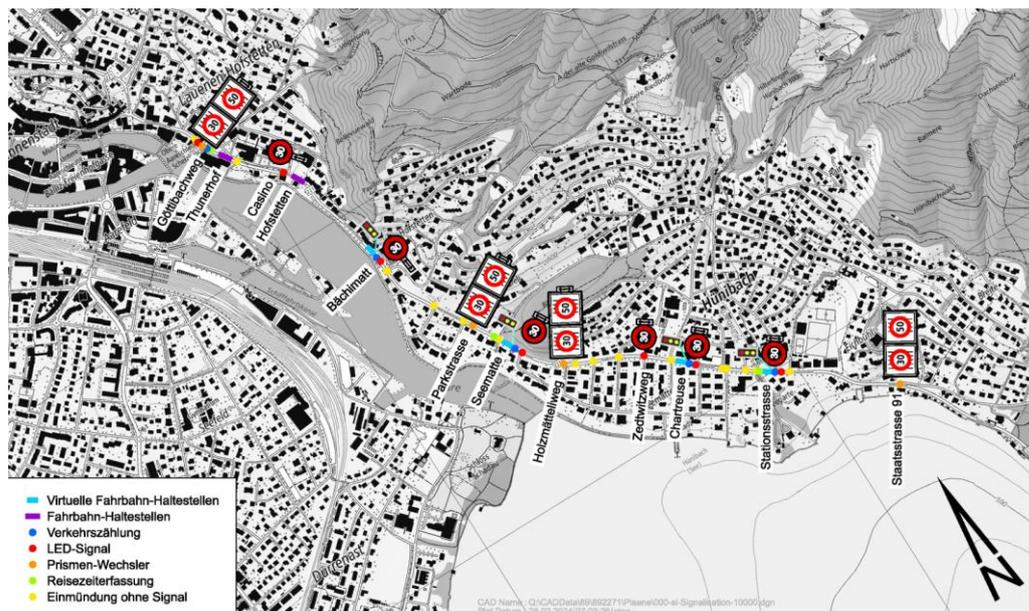
Abbildung: 1. Realisierungsetappe für das Verkehrsmanagement Thun – ReSu mit fünf Lichtsignalanlagen und Tempo-30-Signalisation auf der Staatsstrasse Hiltterfingen bis Hofstettenstrasse Thun
